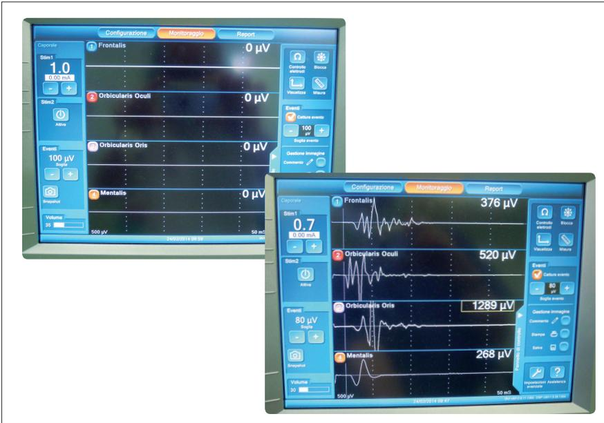
Fig. 2 – Display del NIM (Nerve Intra-operative Monitoring). Per il report del monitoraggio vedere Appendice pag. 87.
